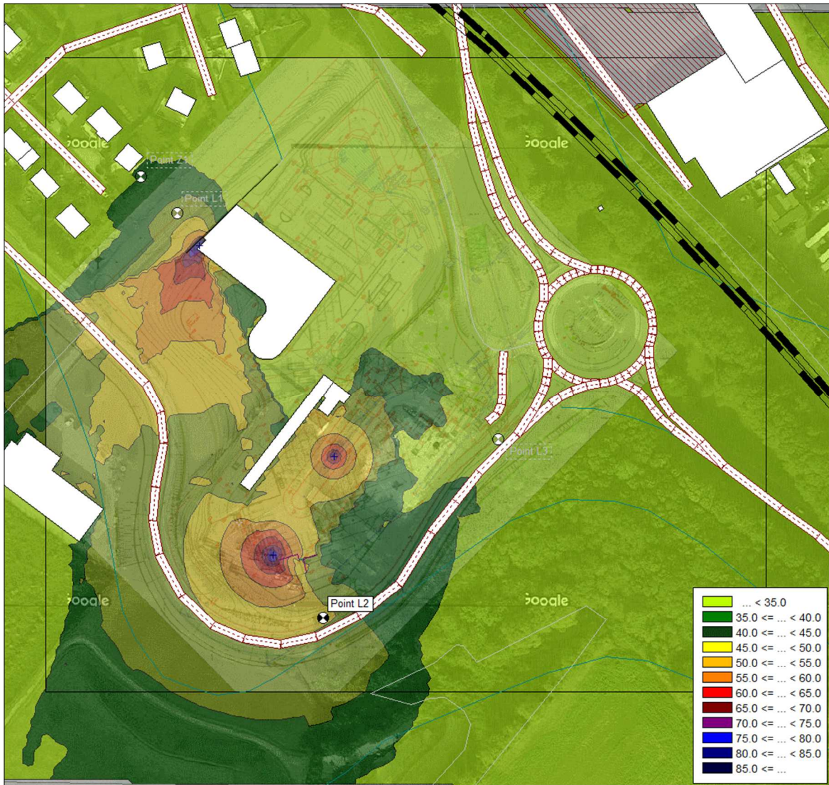
Figure 12 : Cartographie des impacts sonores en dB(A) – Calculs au point L2
